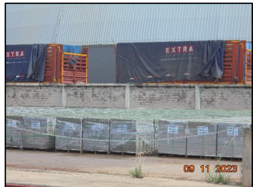
ภาพที่ 2.29 การนำหลัก 3R มาประยุกต์ใช้ (อิฐ Pro Block จาก Fly Ash)
