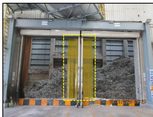
ภาพที่ 2.12 แผ่นม่านประตูภายในอาคารเก็บเชื้อเพลิง
